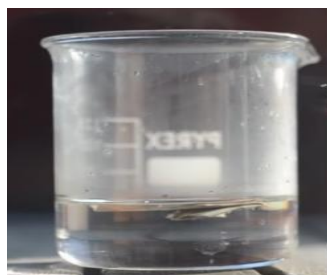
Cốc chứa dung dịch H_2CO_3 khi thả Fe vào
