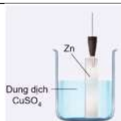
Hình 15.6. Nhúng thanh Zn vào dd \text{CuSO}_4
