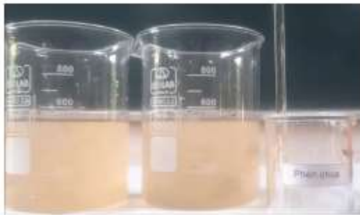
Hình 2. Thí nghiệm làm giảm độ đục của mẫu nước sinh hoạt
