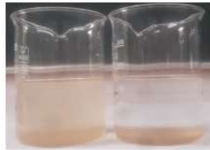
Hình 2. Thí nghiệm làm giảm độ đục của mẫu nước sinh hoạt
