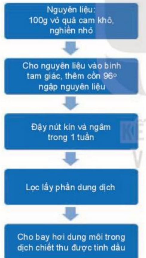
Hình 4.2. Sơ đồ tách tinh dầu vỏ cam bằng phương pháp ngâm chiết
