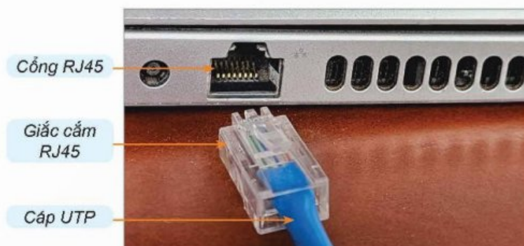
Hình 3.8. Giắc cắm và cổng RJ45
