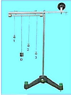
Hình 6.3. Thí nghiệm về dao động cưỡng bức
