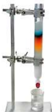
Hình 11.8. Thiết bị, dụng cụ thực hiện tách chất bằng phương pháp sắc kí cột
