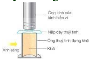
Hình 8.1. Sơ đồ thí nghiệm quan sát chuyển động Brown trong không khí
