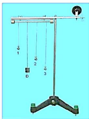
Hình 6.3. Thí nghiệm về dao động cưỡng bức
