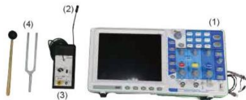
Hình 10.3. Bộ thí nghiệm đo tần số sóng âm
