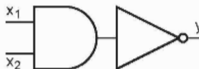
Hình 21.16. Cấu tạo cổng NAND từ AND và NOT
