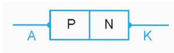
Hình 16.3. Cấu tạo của diode
