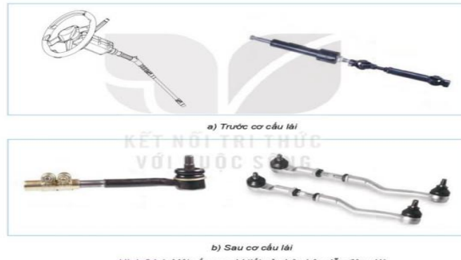
Hình 24.4. Một số cụm chi tiết của bộ phận dẫn động lái
